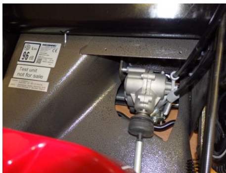
Pohon sekačky je zajištěn pomocí kardanu
